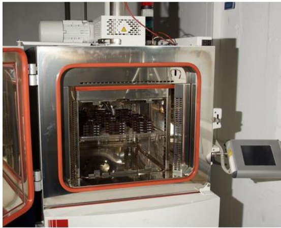
Abb. 73: Prüfkammer mit Probekörper (links) sowie Verlauf der Temperaturschockzyklen an Luft (rechts)
