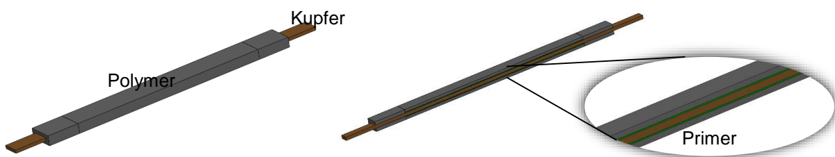
Abb. 65: Eingesetztes Modell für die FEM-Simulationsprogramm ANSYS zur Analyse der Metall-Kunststoff-Verbindung
