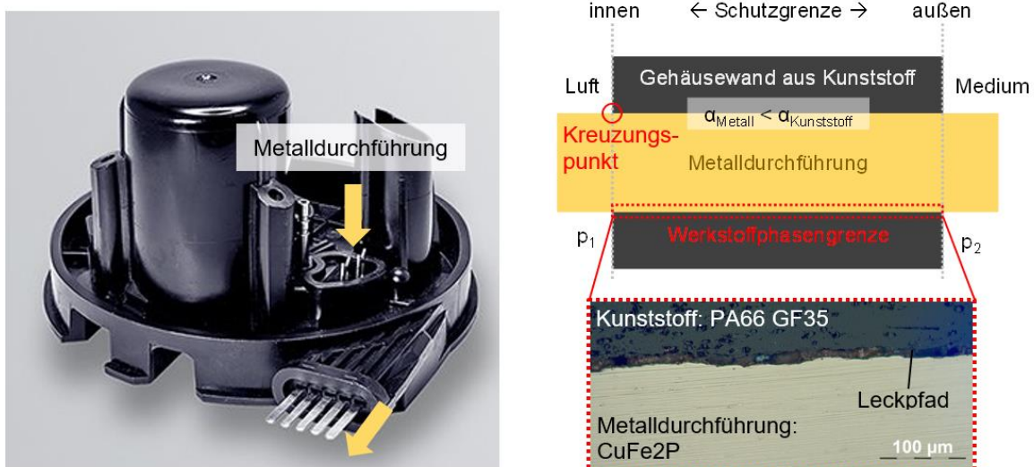
Abb. 1: Links: Kunststoffgehäuse mit elektrischen Durchführungen (Stanzgitter) aus Metall (Quelle: Söhnergroup), Rechts: Werkstoffphasengrenze einer Metalldurchführung im Gehäuse: Schematisch (oben) und über Querschliff mit Leckpfad zwischen Metall und Kunststoff (unten)
