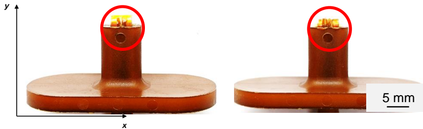
Abb. 95: Bilder der Dualbond LKT-Probe mit dem handgefertigten Kanal nach 1000 Temperaturzyklen
