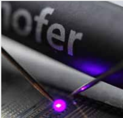
Leuchtbildaufnahme von blau emittierenden Mikro-LEDs auf flexiblem Substrat. Zum Größenvergleich ein schwarzer Bleistift im Hintergrund.
