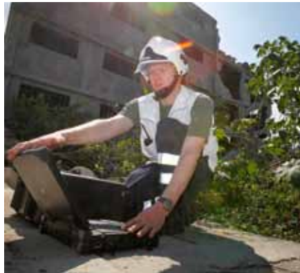
Einsatz des am Lehrstuhl entwickelten Bioradars zur Suche nach Verschütteten in Port au Prince, Haiti, nach dem schweren Erdbeben im Januar 2010
