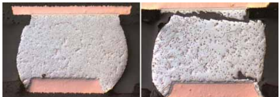
Bleifreie Lötstelle vor und nach Testbelastung
