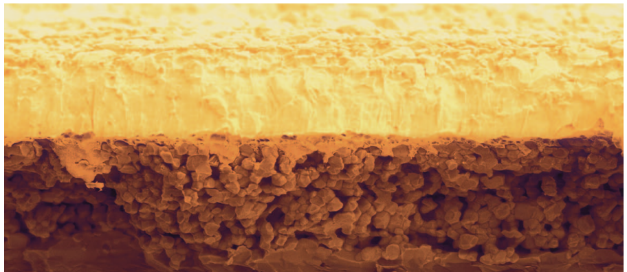
Steuerbare keramische Dickschicht mit Metallisierung – ein Arbeitsgebiet des Lehrstuhls von Prof. Haußelt
