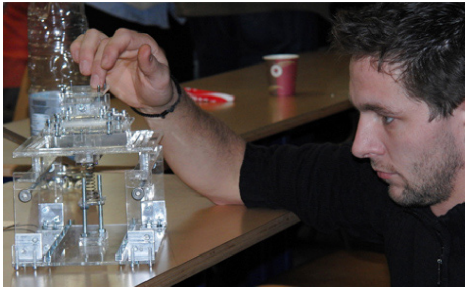
Ein Student prüft den selbstgebauten Sockel des Kraftmikroskops
