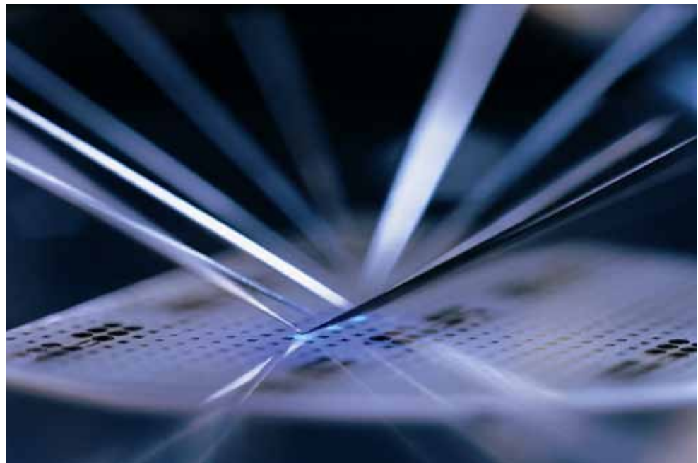
Vorcharakterisierung blauer Leuchtdioden auf einem Wafer Foto: IMTEK
