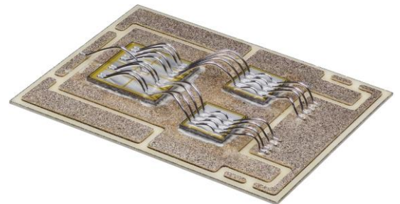
Leistungsmodule aus IGBT und Dioden auf DCB Substrat
