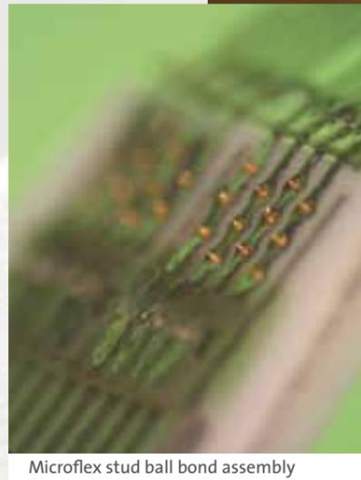
Microflex stud ball bond assembly
